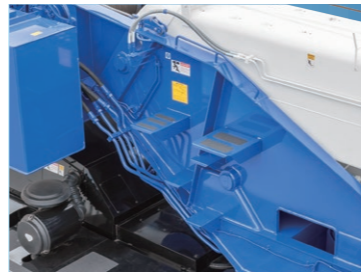
Escalones en la superestructura
