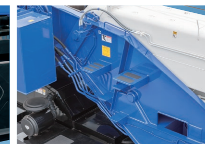
Escalones en la superestructura
